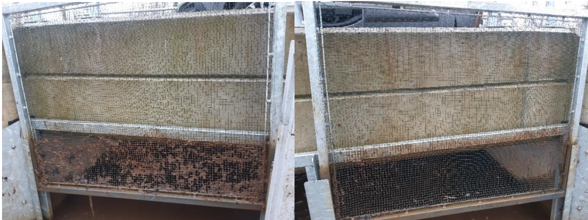
Figuur 41: Omhooggetakelde zijpanelen. Links: onvoldoende gereinigd. Rechts: voldoende schoon. © Mechtild Zoeter Vanpoucke, PCM.
