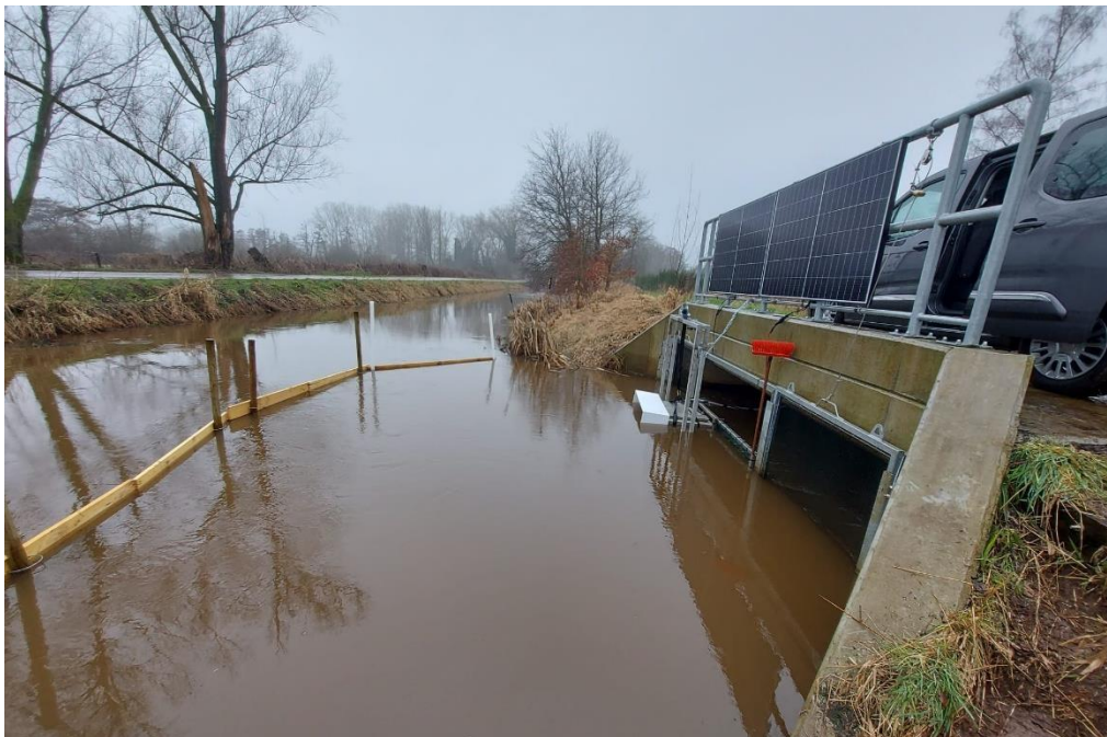
Figuur 40: Opstelling sinds 09/03/2023 met dubbele drijfbalken en zonnesherm op camerabox. © Mechtild Zoeter Vanpoucke, PCM.
