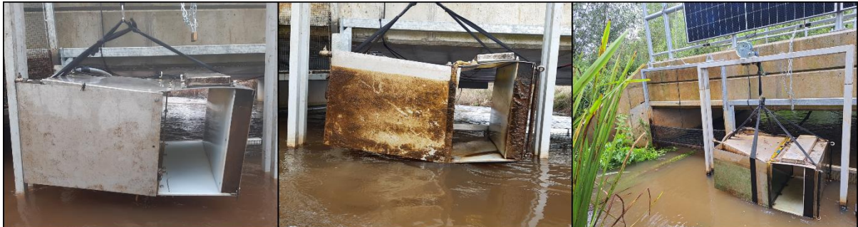
Figuur 6: Links en midden: doorbuigende camerabox en tunnel tijdens onderhoud op 9 maart en 13 april 2023. Rechts: De camerabox en tunnel werden verstevigd door toevoegen van een extra draagriem die dwars werd gelegd. Foto genomen tijdens onderhoud op 30 augustus 2023. ©Mechtild Zoeter Vanpoucke.
