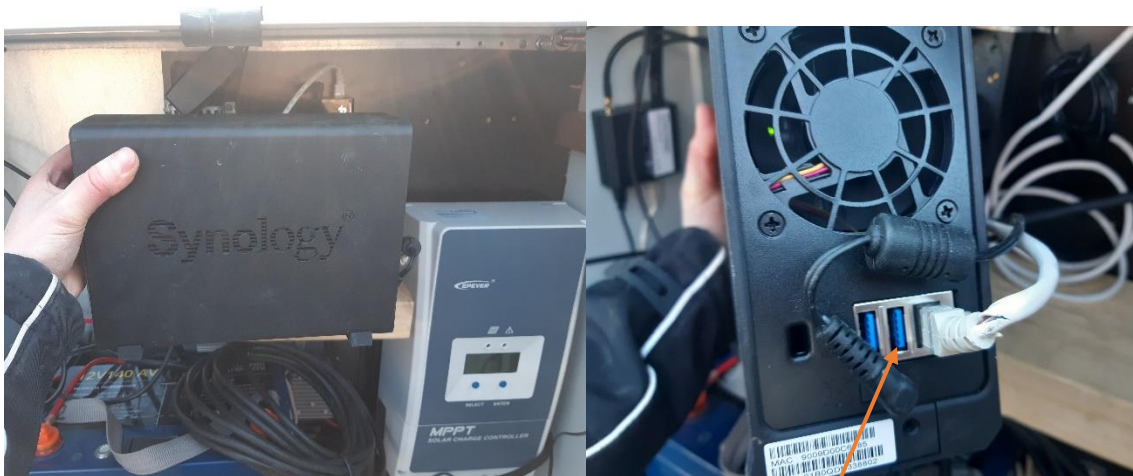
Figuur 46: Locatie van USB-poort voor de USB-stick. © Mechtild Zoeter Vanpoucke, PCM.
