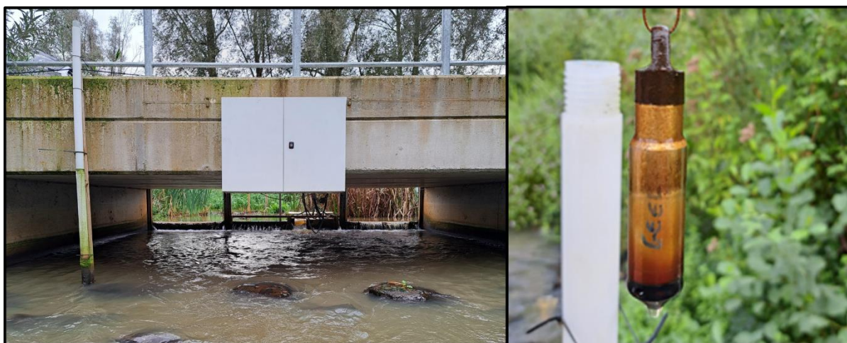
Figuur 4: Links: stroomafwaartse zijde van brug met links de peilbuis en centraal de kast met technische voorzieningen. Foto van beginperiode van het onderzoek met opstuwning door verstopping van de gaaspanelen. Rechts: de diver die in de peilbuis hing. ©Mechtild Zoeter Vanpoucke.
