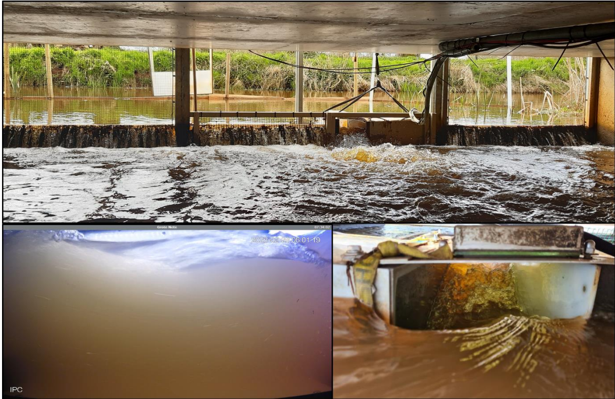
Figuur 9: Beelden van opstuwung bij verstopping van het gaas. Boven: verstopping van het gaas in april 2023 zorgt voor een opstuwung van circa 20cm en turbulente, snelle stroming in de cameratunnel. Onder: turbulente stroming met te hoge stroomsnelheden (zie verder) in de cameratunnel wat migratie bemoeilijkt en de bewegingssensor van de het camerasysteem activeert. ©Mechtild Zoeter Vanpoucke.
