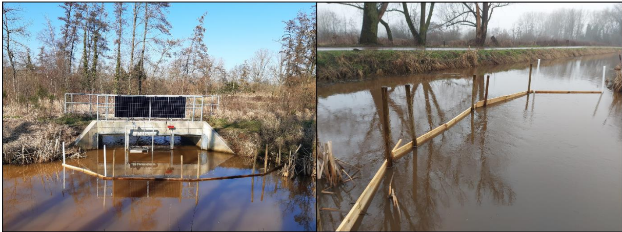
Figuur 8: Foto's van de drijfbalken bij de opstelling. Links met enkele drijfbalk, rechts met dubbele. ©Mechtild Zoeter Vanpoucke.
