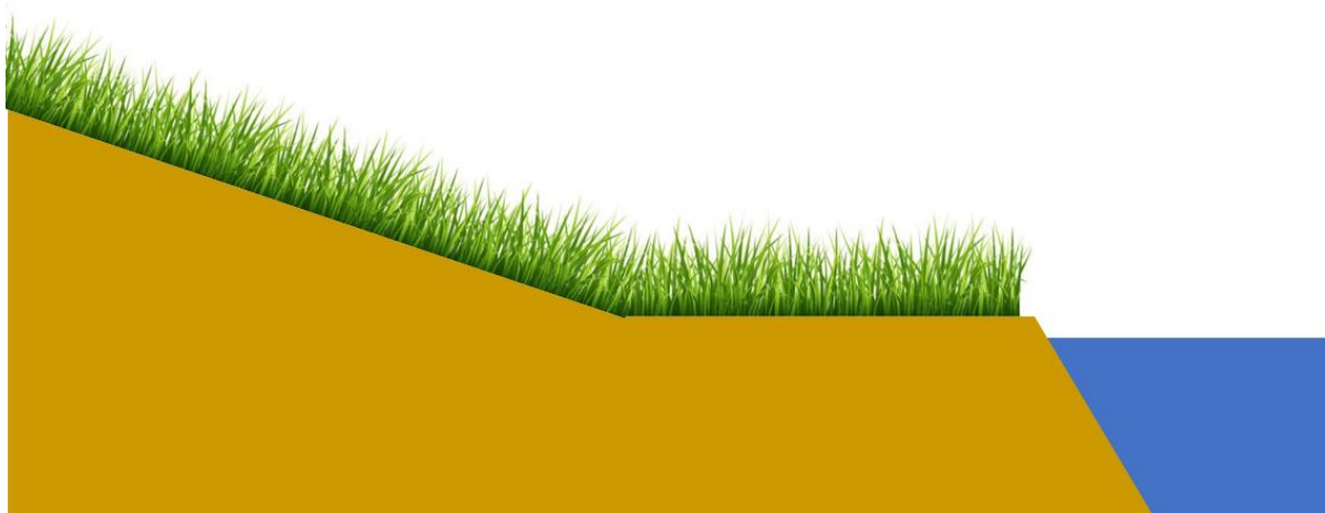
Figuur 2.2.8: Schematische voorstelling van een verflauwde oever in combinatie met een verlaagde oeverzone langs het water.
