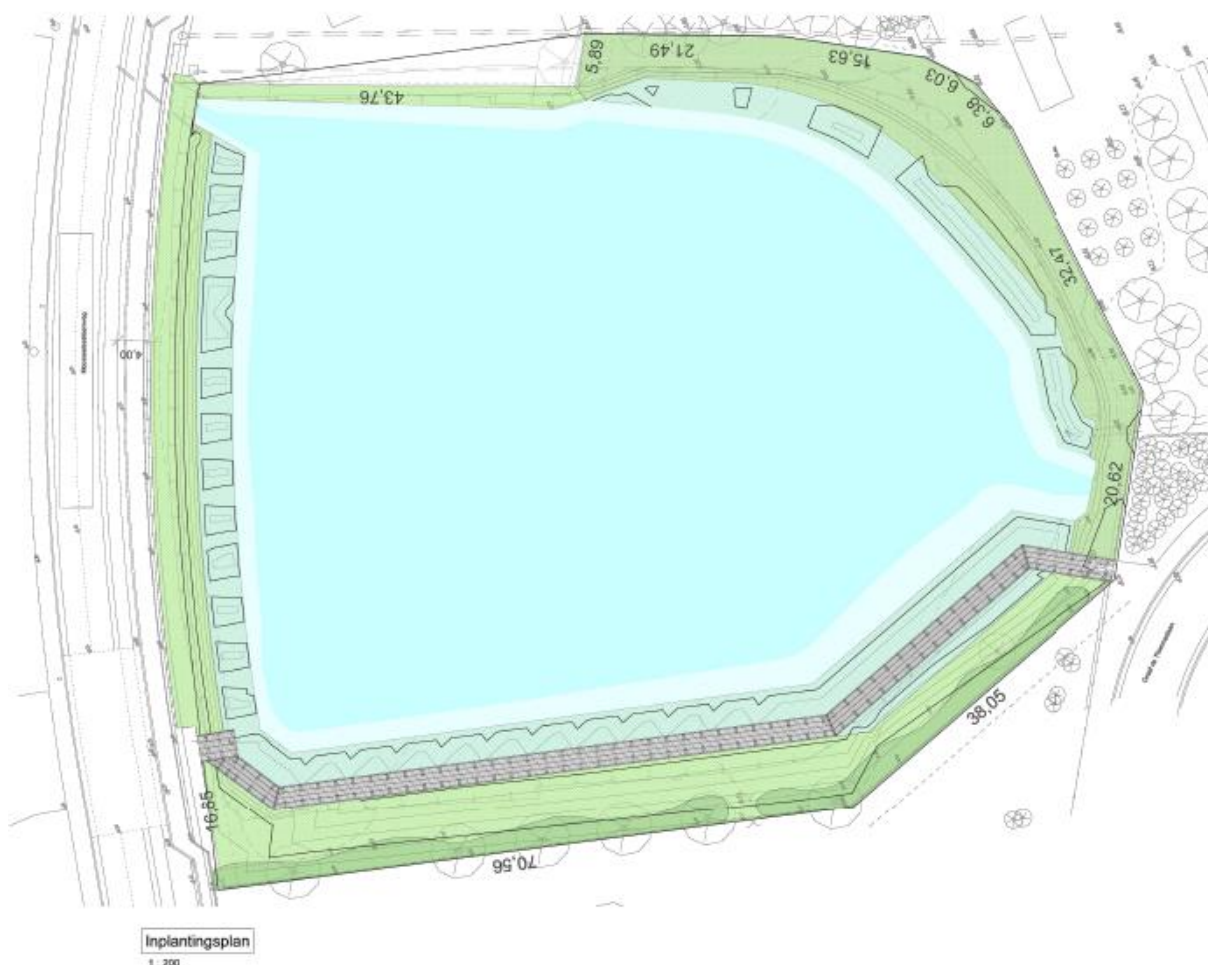
Figuur 25: Inrichtingsplan vijver overzijde Sterrebos (20w) met plasbermen en vlonderpad
