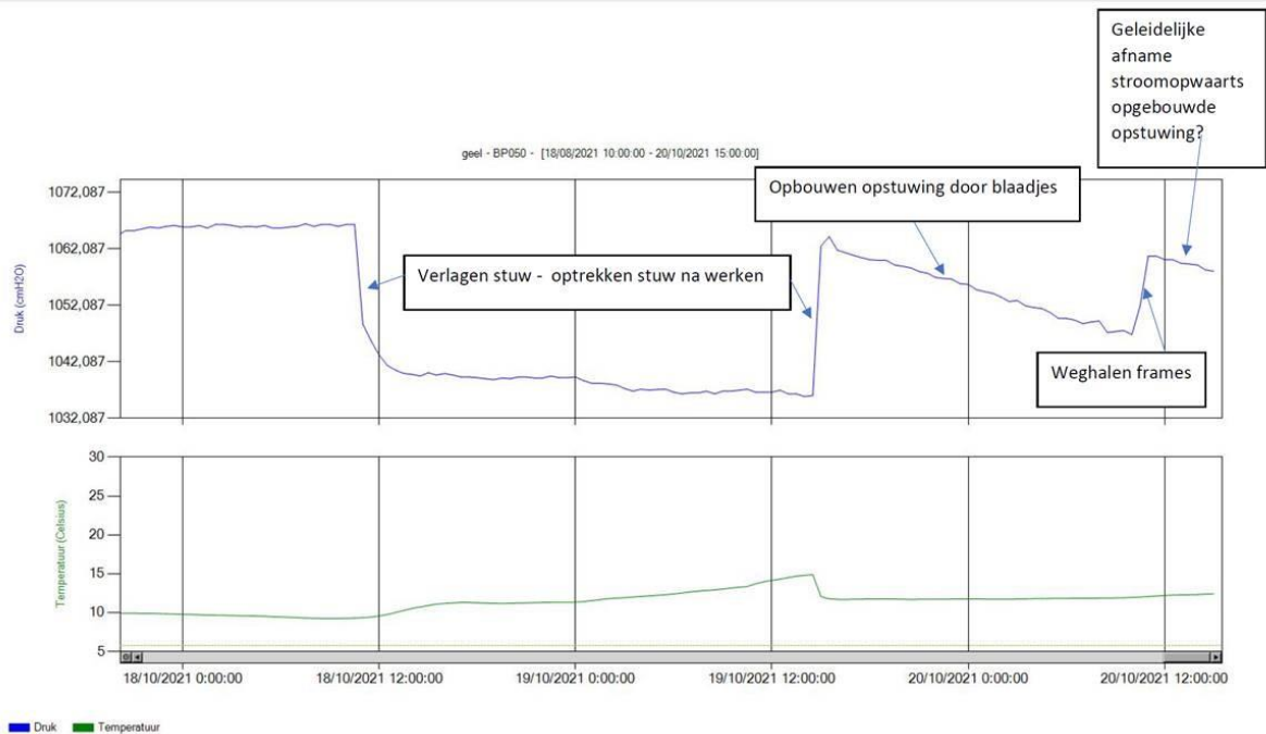
Figuur 9: meting van de waterdruk en temperatuur. Het dalen van de waterdruk is duidelijk merkbaar door de dalende lijn tussen het optrekken van de stuw na de werken en het weghalen van de frames.
