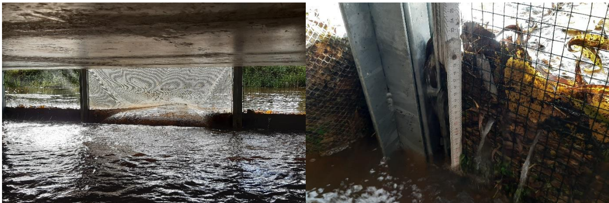
Figuur 8: Bladval hoopte op tegen de zijschermen en onder de fuik waardoor er een invloed was op de lokstroom en de fuik niet optimaal werkte.
