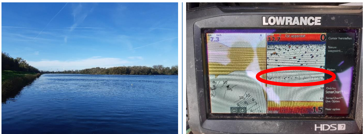
Foto 4 Impressie van Hazewinkel. Foto links: locatie HW_EL2, foto rechts: indicatie spronglaag op circa 8 meter diepte.
