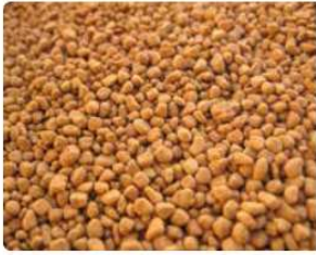
Foto: ICS-korrels gebruikt als filtermateriaal voor fosfor
