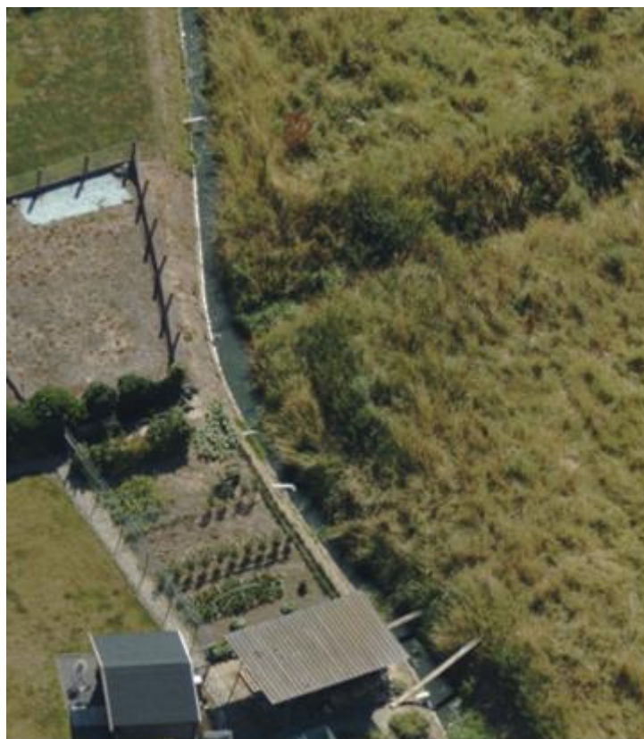
Figuur 21 – Illustratie OS367 tussen Molenstraat en Stationsstraat met verstevigde oevers en tal van buizen die er in uitmonden.
