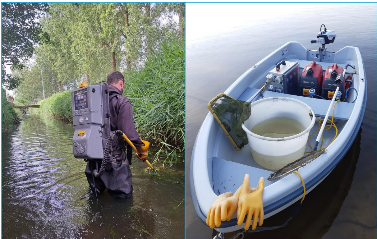
Figuur 4: Links: wadend afvissen met rugtuistel op locatie 702. (© Mechtild Zoeter Vanpoucke). Dit werd ook toegepast op locaties 703 en 705. Rechts: Boot met materiaal voor elektrisch afvissen (archieffoto PCM, © Mechtild Zoeter Vanpoucke)
