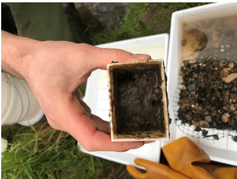
Figuur 5 – foto van een Vibert box op locatie 1 (Zwalmolen) na de eerste controle (24/01/2020) met duidelijke afzet van sediment.
